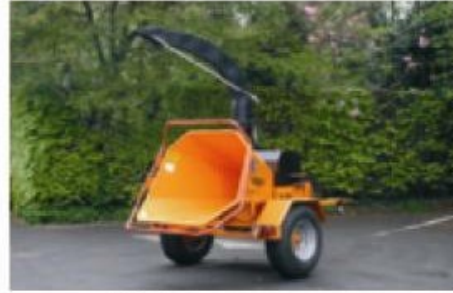
TVI 180 P ; Tractor aangedreven, wielstel traag vervoer (optie)
